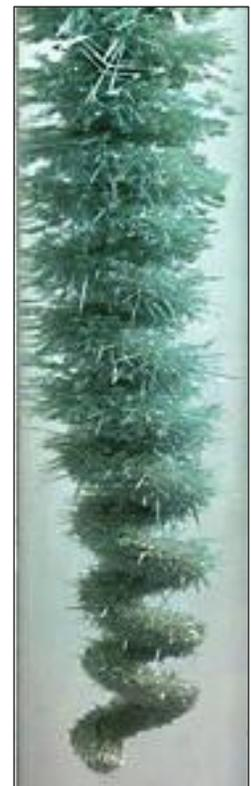
Crece *whiskers* en una bobina de cobre cuando se sumerge en nitrato de plata.
