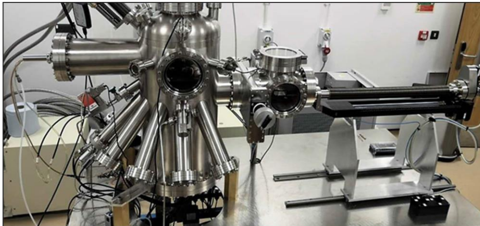
这种新发明的矩阵装配团簇源 (MACS) 机器用于生产银原子催化剂。
