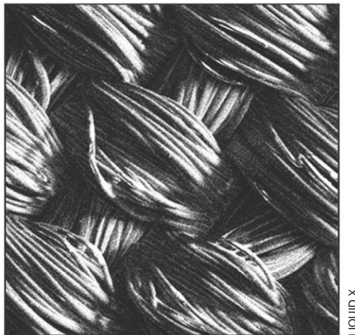
Liquid X 无颗粒墨水在聚酯织物上的电子显微图像。
