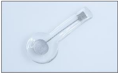
这种用于心电图 (ECG) 的含银薄片全水凝胶电极是 3D 打印的。
